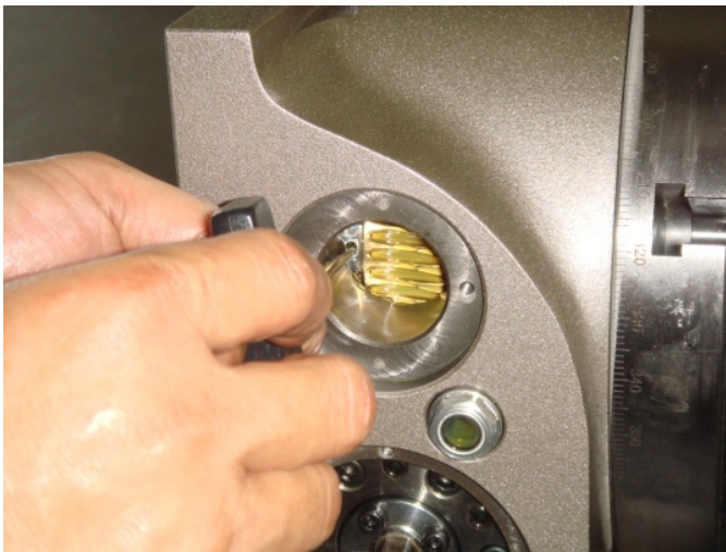
圖 11. 原點復歸格距量調整
