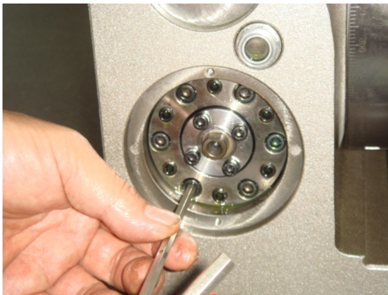
圖 7. 蝸桿蝸輪背隙調整圖
