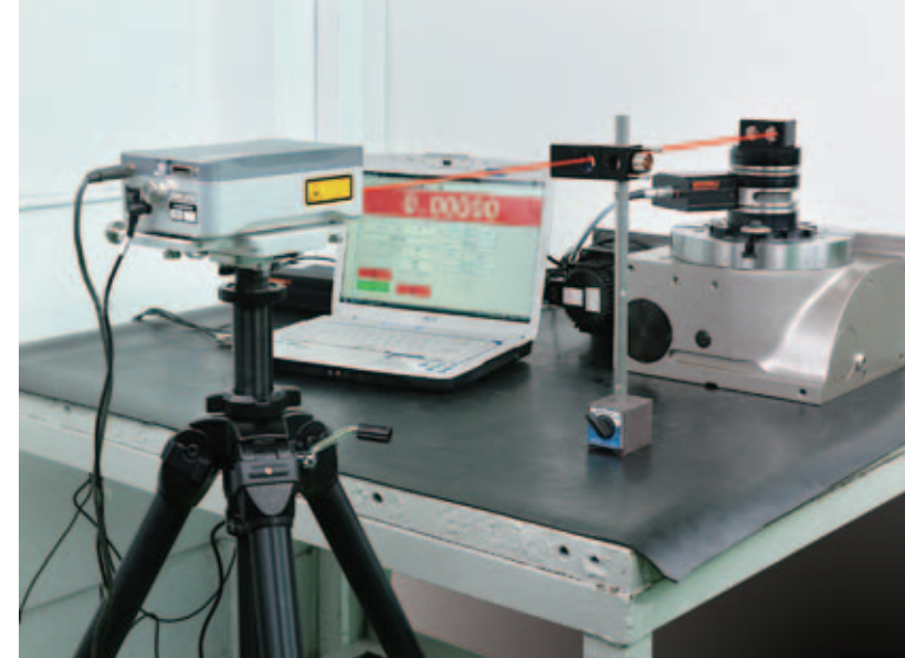
Renishaw鐳射(激光)儀器用於檢測分割精度
